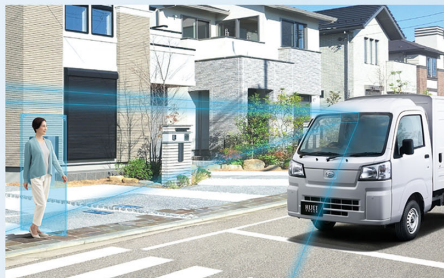
■写真はステレオカメラが前方の歩行者を検知しているイメージです。■車種により一部機能が異なります。 Photo：パナソニック 4WD 5MT。
