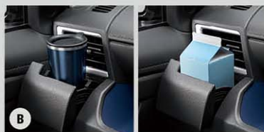
回転式カップホルダー(運転席/助手席) 角型パック、ペットボトルなどの丸型に対応。 閉じればスマートフォン立てにも使用可能。
