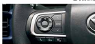
ステアリングスイッチ(パノラマモニター及び 駐車支援用)
