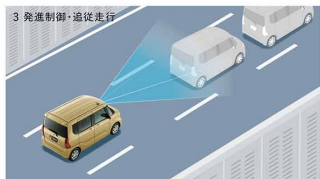
3 発進制御・追従走行 先行車が発進している状態で"RES"スイッチを押す、またはアクセルを踏むと、追従走行に戻ります。
