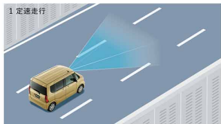
1 定速走行 先行車がない場合は、ドライバーが設定した速度で定速走行します。
