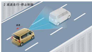
2 減速走行・停止制御 先行車を認識した場合は、先行車の車速に合わせて減速し、先行車が停止すると、先行車に続いて停止します。(停止保持時間は最長約3分間)
