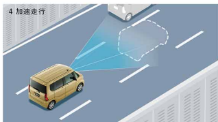
4 加速走行 設定した速度より車速が遅い車がいなくなると、設定速度まで加速し、定速走行へ移行します。
