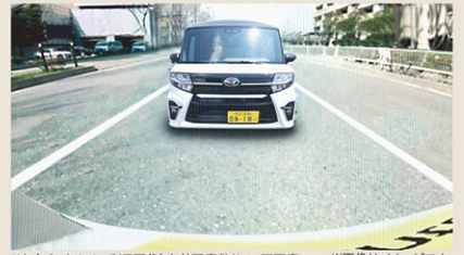
リヤ(バックカメラ利用画像)有効画素数約30万画素 ※車両距離は約2mの画像です。
