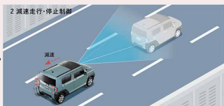
2 減速走行・停止制御 先行車を認識した場合は、先行車の車速に合わせて減速し、先行車が停止すると、先行車に続いて停止します。(停止保持時間は最長約3分間)
