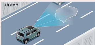
4 加速走行 設定した速度より車速が遅い車がいなくなると、設定速度まで加速し、定速走行へ移行します。
