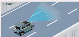
1 定速走行 先行車がない場合は、ドライバーが設定した速度で定速走行します。
